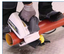
1、Exact切割器該管確保精確,快速和安全的切割沒有飛濺的火花和熱片。
